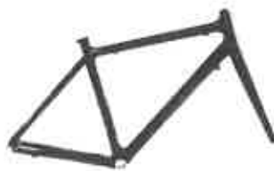
1980 ALLA RICERCA DELL'EQUILIBRIO PERFETTO TRA LEGGEREZZA E RESISTENZA SI INIZIA AD UTILIZZARE LA FIBRA DI CARBONIO IN ALTERNATIVA ALL'ACCIAIO E ALL'ALLUMINIO
